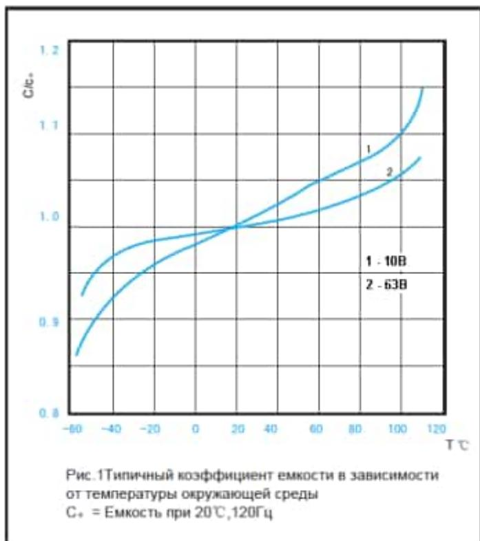
Рис.1 Типичный коэффициент емкости в зависимости от температуры окружающей среды
