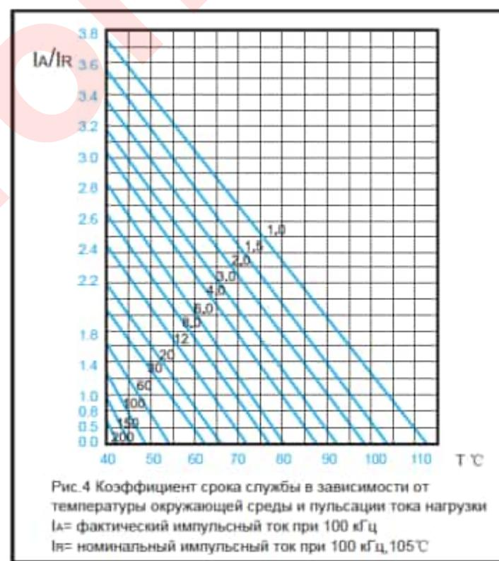
Рис.4 Коэффициент срока службы в зависимости от температуры окружающей среды и пульсации тока нагрузки
