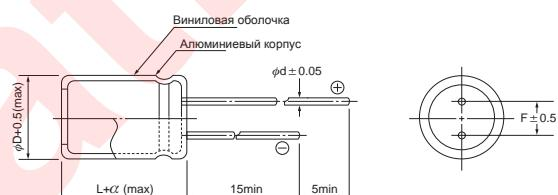
Габаритные размеры корпуса & максимальный импульсный ток
