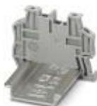
Концевой держатель для быстрого монтажа, для монтажной рейки NS 35/7,5 или NS 35/15, с возможностью нанесения маркировки и установки FBS...5, FBS...6, KSS 5, KSS 6, ширина: 5,15 мм, цвет: серый
