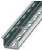
DIN-рейка, с перфорацией, Стандартный профиль, ширина: 35 мм, высота: 15 мм, соотв. EN 60715, материал: Сталь, оцинковка, белая пассивация, длина: 2000 мм, цвет: серебристый
