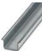
Несущая рейка без перфорации, Стандартный профиль, ширина: 35 мм, высота: 15 мм, соотв. EN 60715, материал: Сталь, оцинкованный, длина: 2000 мм, цвет: серебристый
