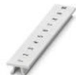
Планка Zack, Полоса, белый, с маркировкой, маркируется с помощью: CMS-P1-PLOTTER, надписи вдоль: нумерация по порядку 1 ...10, 11 ...20 и т.д. до 491 ...500, тип монтажа: крепление в высоких пазах для табличек, для клемм шириной: 6,2 мм, размер маркировочного поля: 6,15 x 10,5 мм, Количество отдельных табличек: 10
