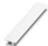
Планка Zack, Полоса, белый, без надписи, маркируется с помощью: PLOTMARK, CMS-P1-PLOTTER, тип монтажа: крепление в высоких пазах для табличек, для клемм шириной: 6,2 мм, размер маркировочного поля: 6,15 x 10,5 мм, Количество отдельных табличек: 10
