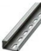
DIN-рейка, с перфорацией, Профиль G, ширина: 32 мм, высота: 15 мм, согласно EN 60715, материал: Сталь, оцинкован., пассивирован., длина: 2000 мм, цвет: серебристый
