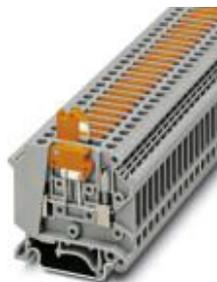
Клеммы с ножевыми размыкателями, с винтами для крепления контрольного штекера, номинальное напряжение: 500 В, номинальный ток: 20 А, тип подключения: Винтовые зажимы, сечение: 0,2 мм<sup>2</sup> - 6 мм<sup>2</sup>, AWG: 24 - 10, длина: 51 мм, ширина: 6,2 мм, цвет: серый, монтаж: NS 32, NS 35/7,5, NS 35/15
