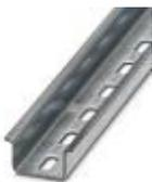
DIN-рейка, с перфорацией, Стандартный профиль, ширина: 35 мм, высота: 15 мм, соотв. EN 60715, материал: Сталь, оцинкованный, длина: 2000 мм, цвет: серебристый
