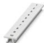
Планка Zack, Полоса, белый, с маркировкой, маркируется с помощью: CMS-P1-PLOTTER, надписи поперек: нумерация по порядку 1 ...10, 11 ...20 и т.д. до 491 ...500, тип монтажа: крепление в высоких пазах для табличек, для клемм шириной: 6,2 мм, размер маркировочного поля: 6,15 x 10,5 мм, Количество отдельных табличек: 10
