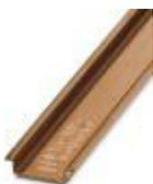
Несущая рейка без перфорации, Стандартный профиль, ширина: 35 мм, высота: 7,5 мм, согласно EN 60715, материал: Медь, без покрытия, длина: 2000 мм, цвет: Под медь
