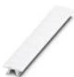
Маркировка для клеммных модулей, Полоса, белый, с маркировкой, маркируется с помощью: CMS-P1-PLOTTER, надписи вдоль: U, V, W, N, GND, U, V, W, N, GND, тип монтажа: крепление в высоких пазах для табличек, для клемм шириной: 6,2 мм, размер маркировочного поля: 6,15 x 10,5 мм, Количество отдельных табличек: 10
