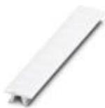
Маркировка для клеммных модулей, Полоса, белый, с маркировкой, маркируется с помощью: CMS-P1-PLOTTER, горизонтально: L1, L2, L3, N, PE, L1, L2, L3, N, PE, тип монтажа: крепление в высоких пазах для табличек, для клемм шириной: 6,2 мм, размер маркировочного поля: 6,15 x 10,5 мм, Количество отдельных табличек: 10
