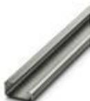
Несущая рейка без перфорации, Профиль G, ширина: 32 мм, высота: 15 мм, согласно EN 60715, материал: Сталь, оцинкован., пассивирован., длина: 2000 мм, цвет: серебристый
