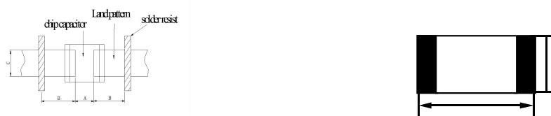
再流焊接时推荐设计的尺寸 (单位: mm)
